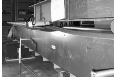
(d) distortional test at failure
